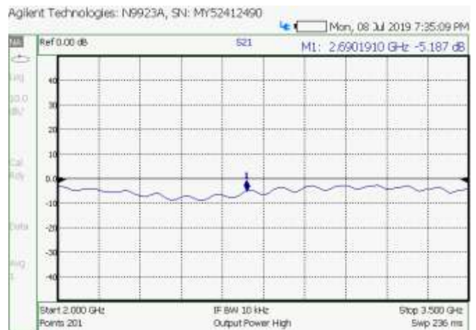
Fig.8. Scattering Parameter at Port (S 21 ) on VNA
